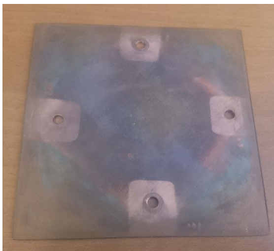
Рисунок 4.15. Автограф пучка на медной мишени в случае несовпадения направления силовых линий соленоида и постоянного магнита внутри рамки
