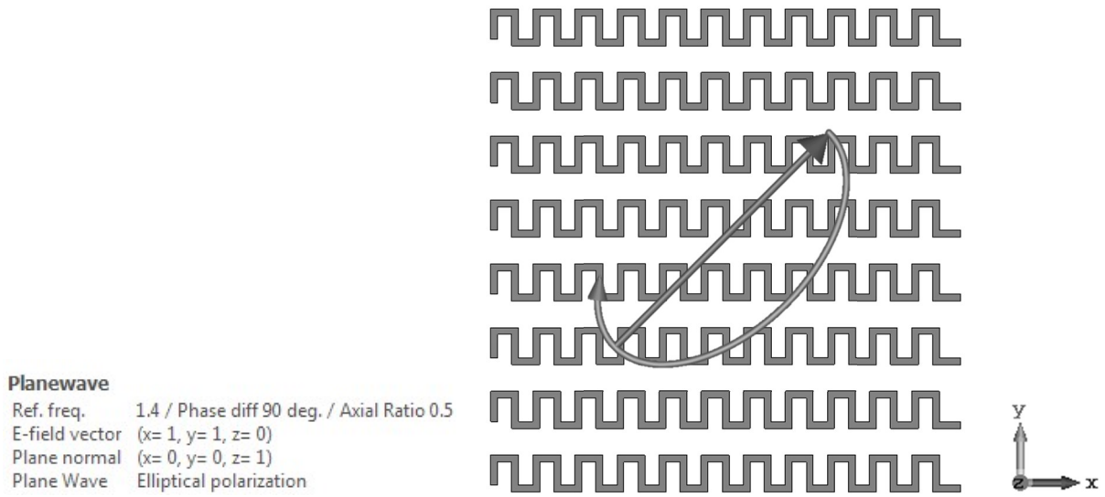
Рисунок 97 – Падение плоской волны эллиптической поляризации на решетку поляризатора меандровой линии (главный вид)
