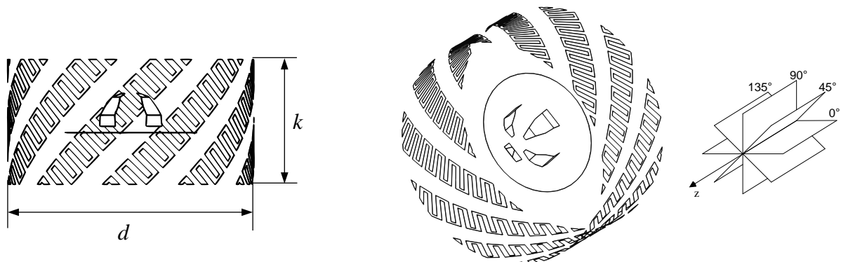
Рисунок 10 – Квадрупольная антенна с поляризатором и исследуемые плоскости азимутальных углов 0^\circ, 45^\circ, 90^\circ, 135^\circ
