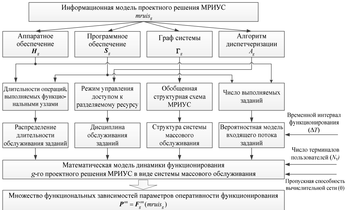
Рисунок 2.1.1 – Обобщенная структурная схема взаимосвязи компонентов предложенной информационной модели проектного решения МРИУС и ее математической модели как СМО
