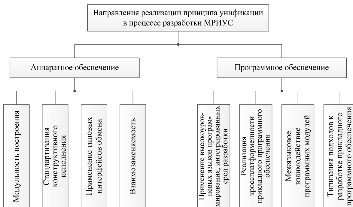
Рисунок 2.2.3 – Направления реализации принципа унификации в рамках методологии проектирования МРИУС
