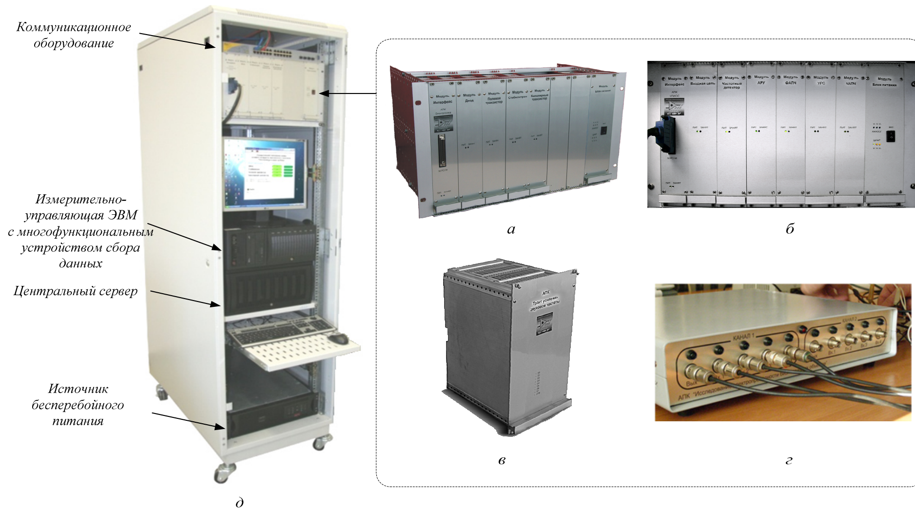
Рисунок 6.1.11 – Примеры конструктивного исполнения аппаратных компонентов промышленных образцов МРИУС автоматизации научных и учебных экспериментальных исследований: а – АПК УД «Полупроводниковые приборы»; б – АПК УД «Устройства приема и обработки сигналов»; в – АПК УД «Тракт усиления звуковой частоты»; г – АПК УД «Электропроводность биологических объектов»; д – размещение промышленных образцов МРИУС в телекоммуникационном шкафу 19" системы конструктивов «Евромеханика»
