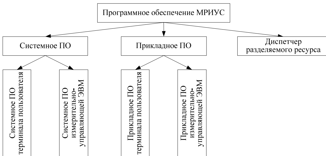
Рисунок 1.2.2 – Структурная схема базовой классификации программного обеспечения МРИУС
