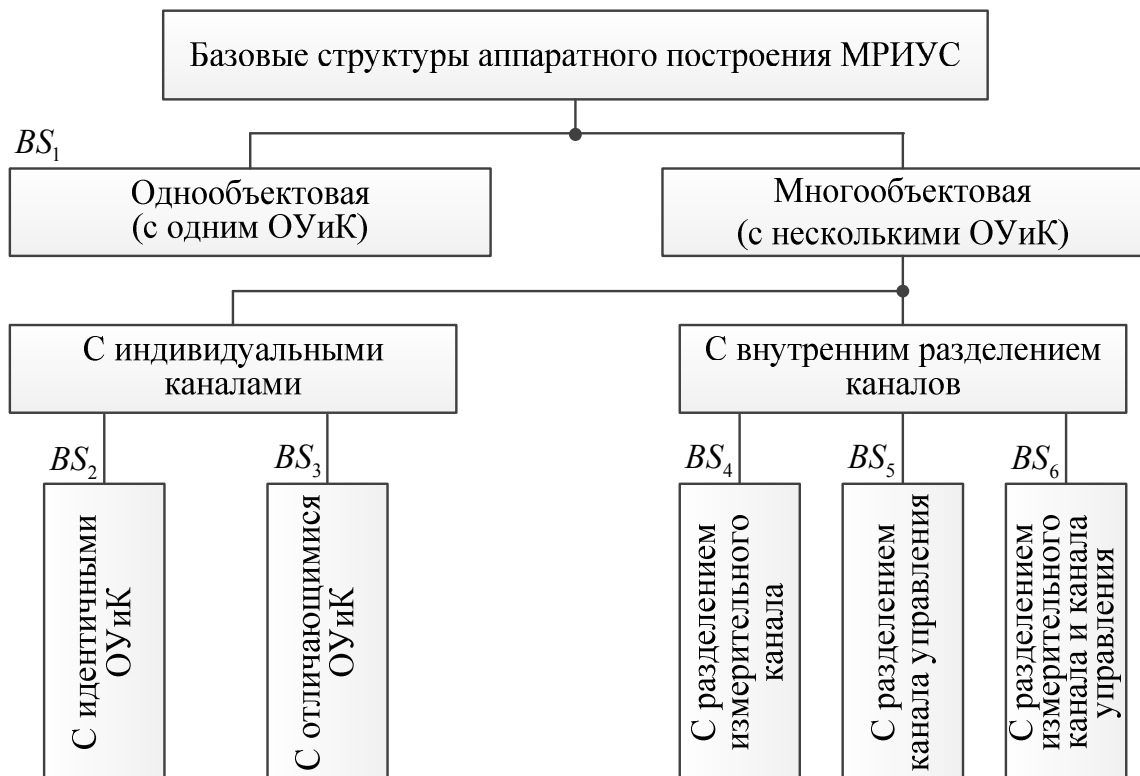
Рисунок 3.1.1 – Классификация базовых структур аппаратного построения МРИУС
