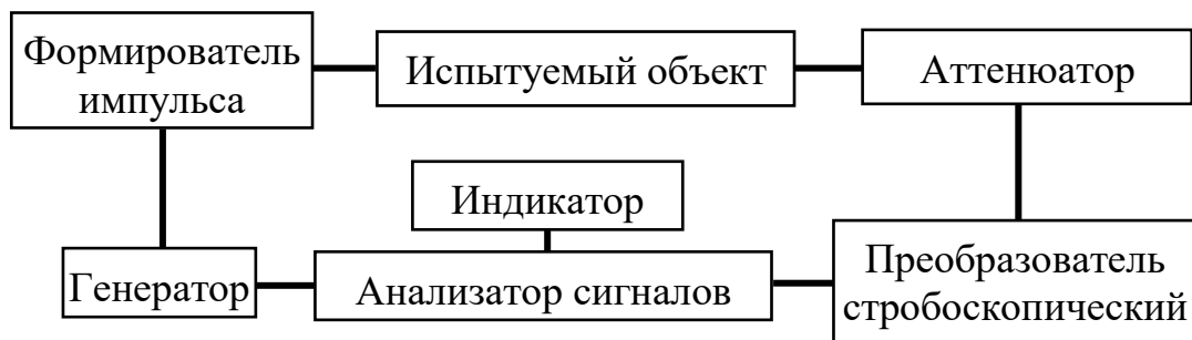
Рисунок 2.65 – Схема экспериментальной установки для измерений во временной области
