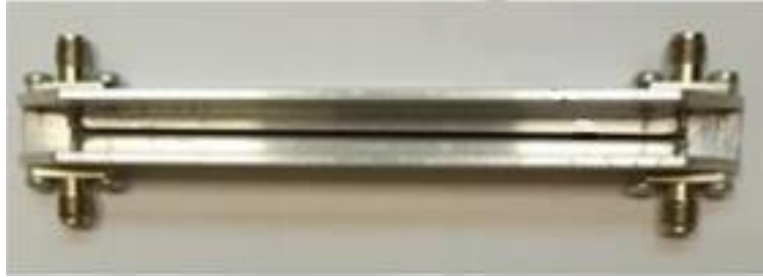
Рисунок 1.6 – Внешний вид направленного ответвителя [81]
