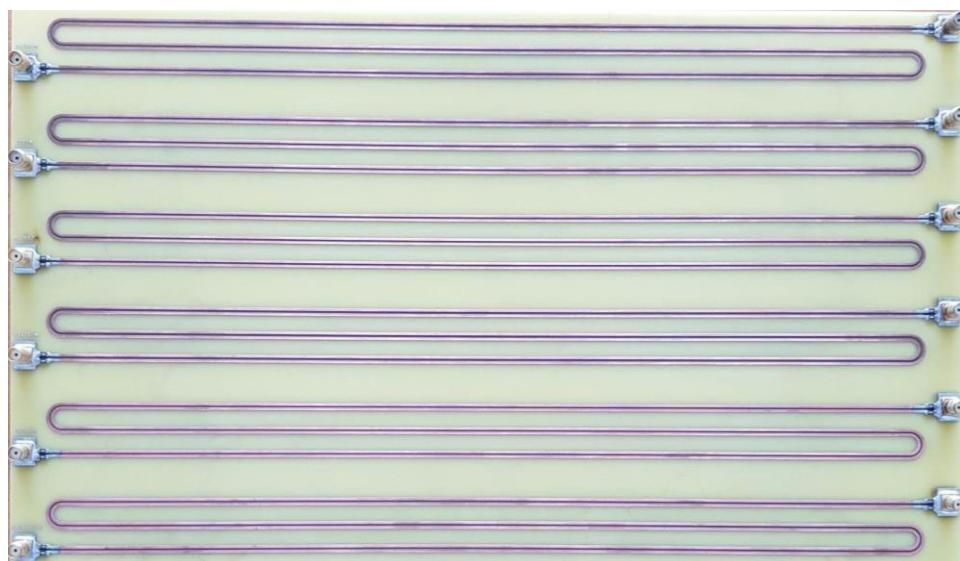
Рисунок 2.63 – Макет 4-слойного зеркально-симметричного МФ
