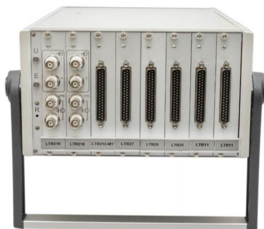
Рисунок 1.12 – Внешний вид модульного устройства сбора данных
