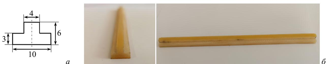
Рисунок 2.46 – Геометрические размеры (а) и внешний вид (б) диэлектрика, заполняющего апертуру
