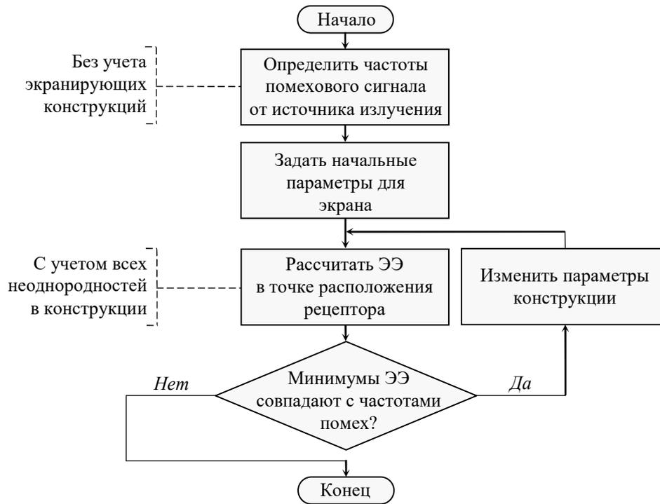
Рисунок 3.45 – Методика оптимизации многоуровневой экранирующей конструкции
