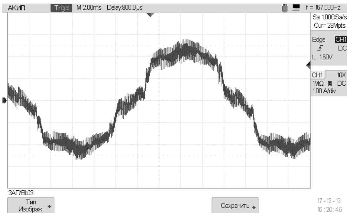
Рисунок 4.18 – Осциллограммы токов сети, снятые при работе АСФ с включенным режимом прогнозирования
