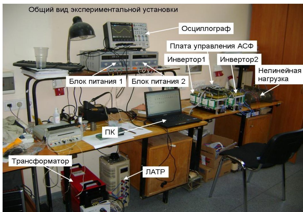
Рисунок 4.14 – Экспериментальная установка АСФ. Общий вид
