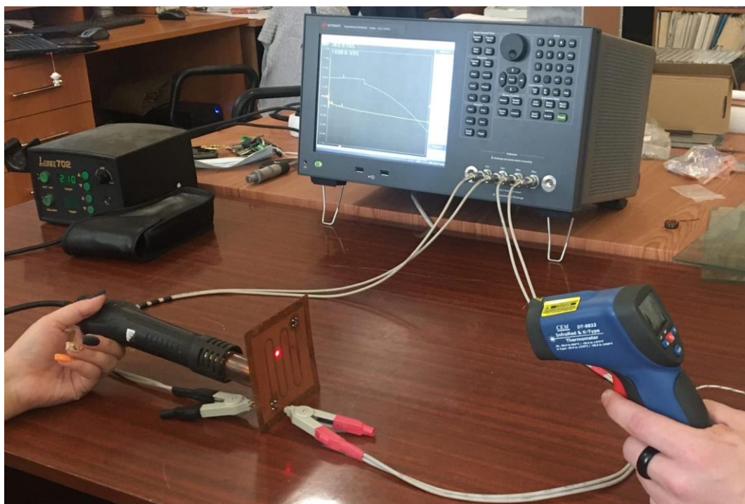
Рисунок 5.21 – Измерение c_{11} при T= 30, 70 и 150 \text{ }^\circ\text{C}
