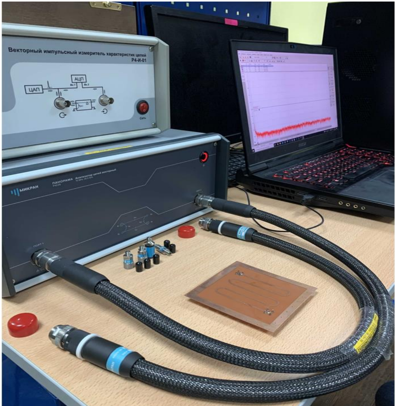
Рисунок 5.13 – Фото макета и векторного анализатора цепей Р4М-40
