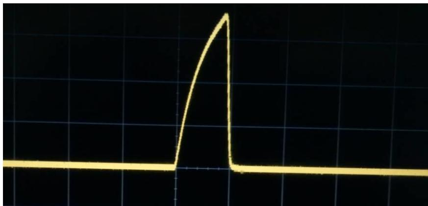
Рисунок 1.9 – Форма оптического импульса Л-13
