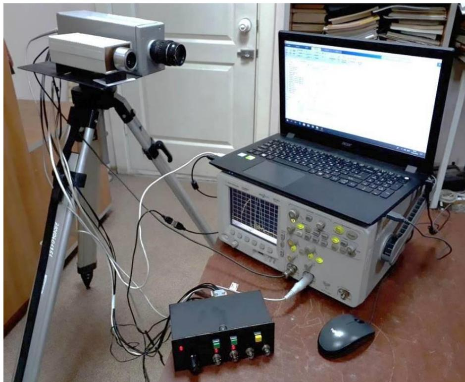
Рисунок 4.5 – Вид экспериментального макета АИ ТИС
