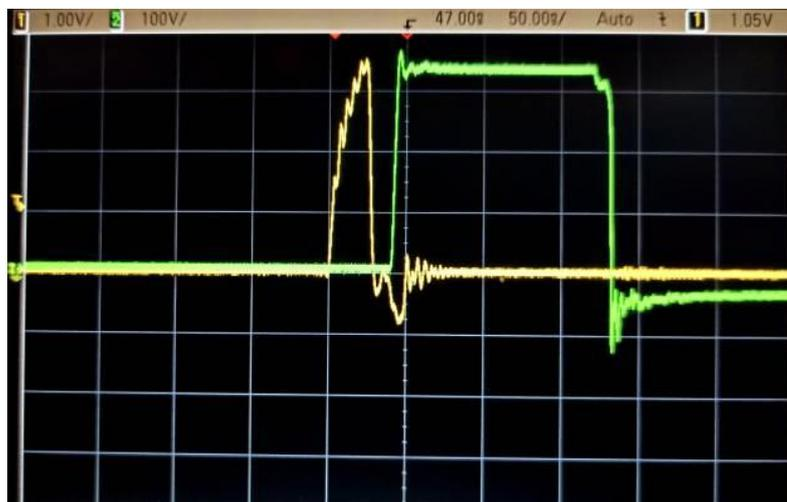
Рисунок 4.7 – Осциллограммы ИПП (желтый) и стробирования ЭОП (зеленый) для формирования первой АЗВ 20-ти зонного ММИД
