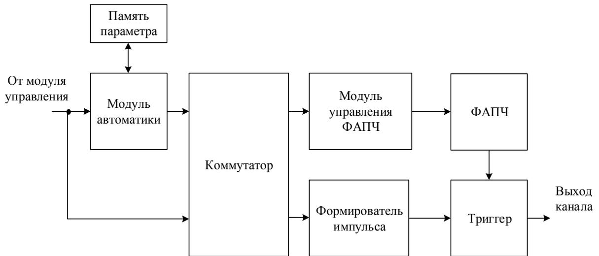
Рисунок 4.2 – Структурная схема модуля формирования выходного импульса
