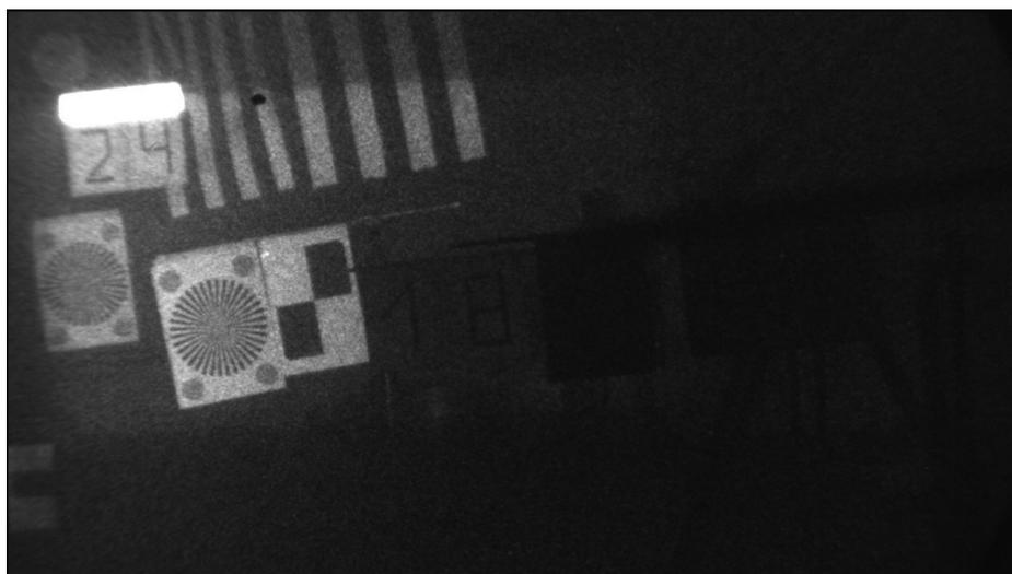
Рисунок 4.37 – Изображение в условиях плотного дыма при длительности ИПП
