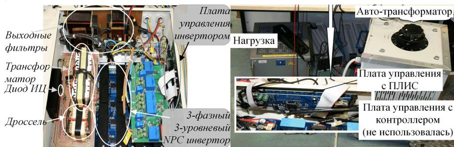
Рисунок 17. Макет экспериментальной установки
