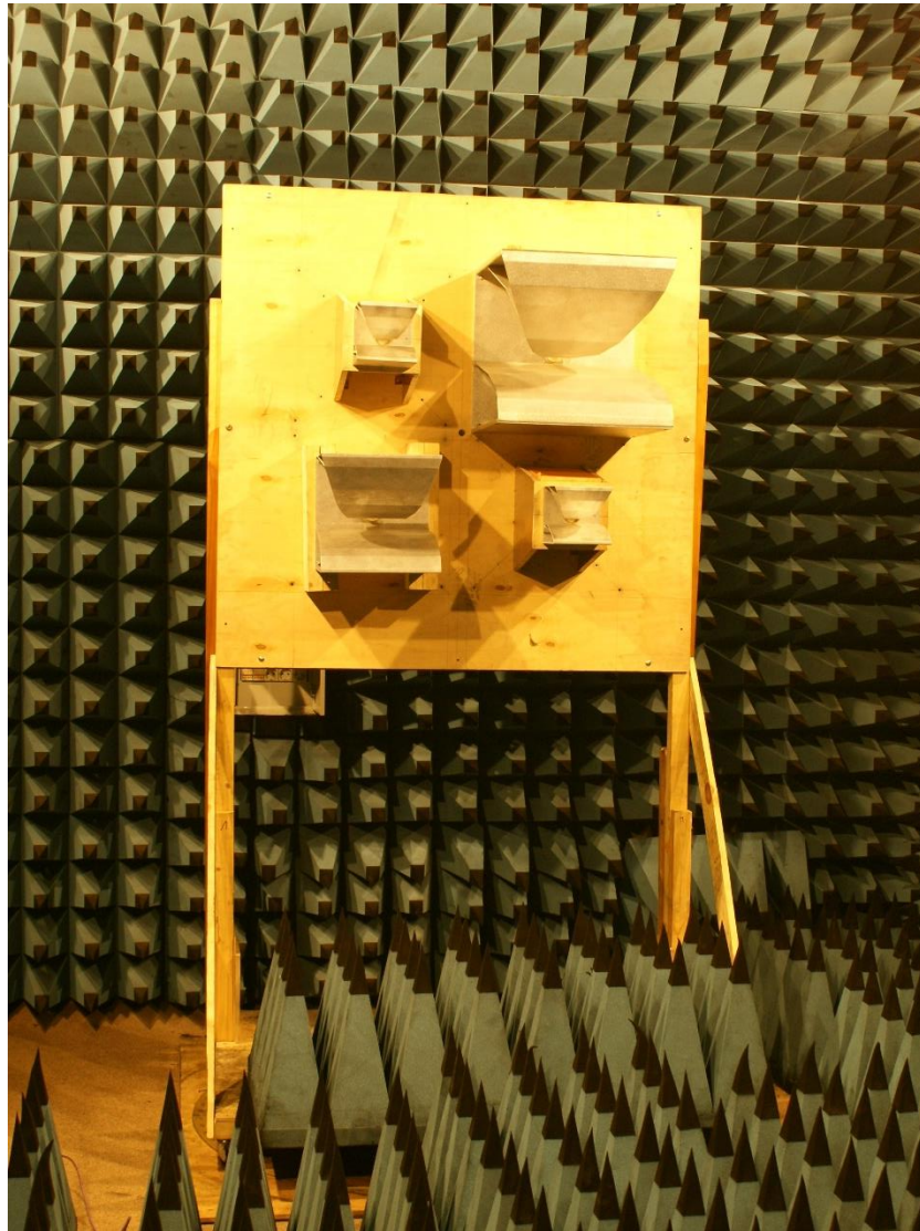
Рисунок 4.26 – Четырехэлементная решетка, возбуждаемая биполярными импульсами длительностью 3 нс, 2 нс, 1 нс и 0.5 нс
