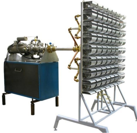
Рисунок 4 – Внешний вид источника СШП-излучения с 64-элементной решеткой
