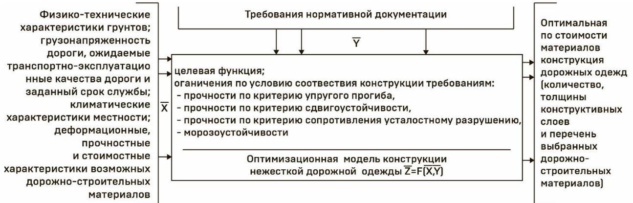
Рисунок 1 – Концептуальная модель расчета конструкции нежестких дорожных одежд
