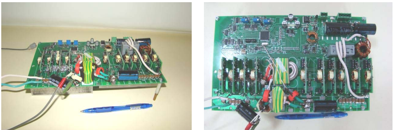
Рисунок 6.6 – Экспериментальный образец вольтодобавочного резонансного преобразователя
