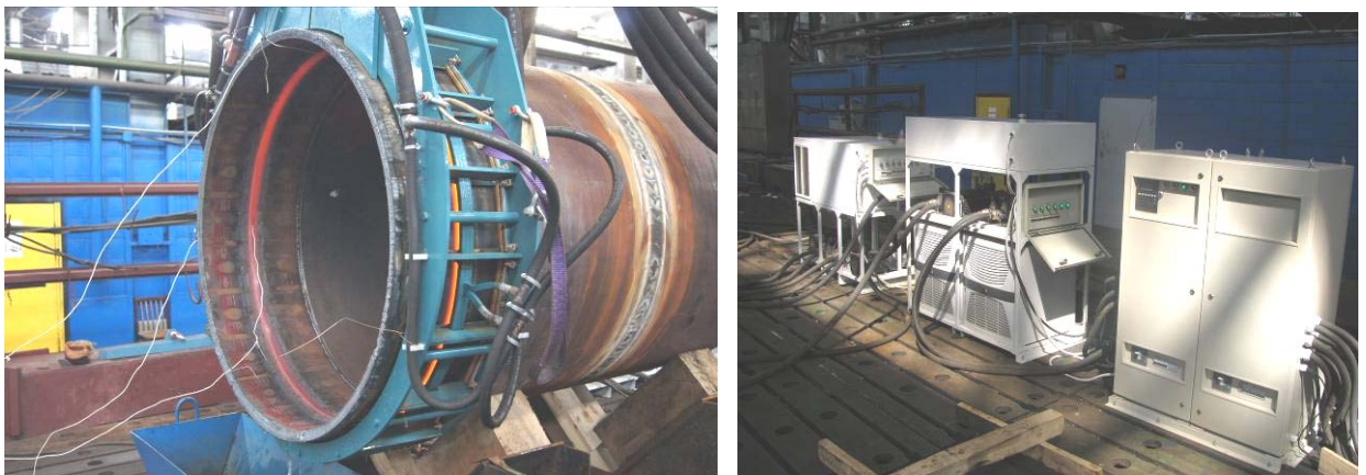
Рисунок 6.19 – Комплекс индукционной термообработки труб на основе резонансного LCLC -преобразователя
