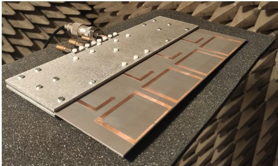
Рисунок 5.16 – Фотографии изготовленной 4-лучевой ФАР: а) устройство в корпусе с лицевой стороны; б) устройство в корпусе с обратной стороны; в) 4-лучевая ФАР в безэховой камере
