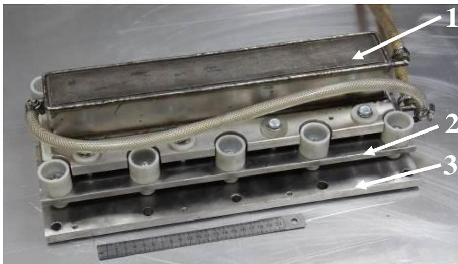
Рисунок 2.3 – Внешний вид источника электронов: 1 – протяженный полый катод; 2 – анод; 3 – ускоряющий электрод
