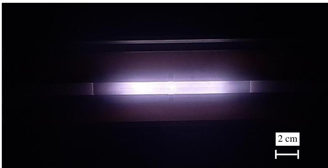
Рисунок 3.12 – Свечение разряда в среде аргона, размер щели в катоде 1×12 мм, давление 20 Па
