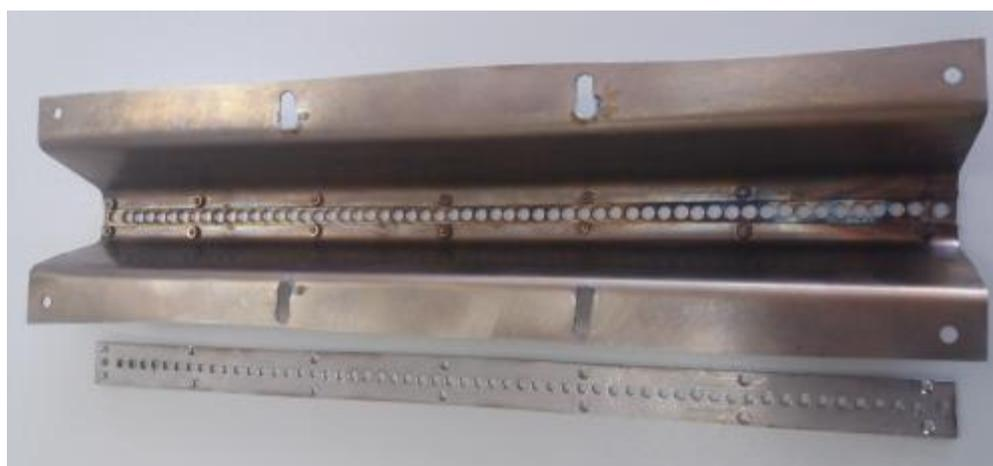
Рисунок 2.9 – Экстрактор форвакуумного плазменного источника электронов
