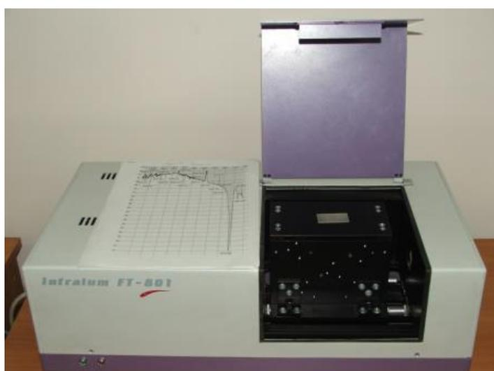
Рисунок 2.24 – Фурье-спектрометр Infracum FT-801
