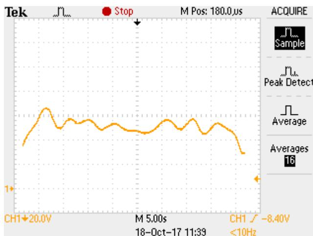
Рисунок 2.14 – Характерный сигнал с осциллографа при измерении распределения плотности тока электронного пучка
