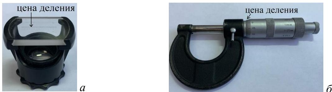
Рисунок 4.11 – Увеличительное стекло с измерительной линейкой (а) и механический микрометр (б)
