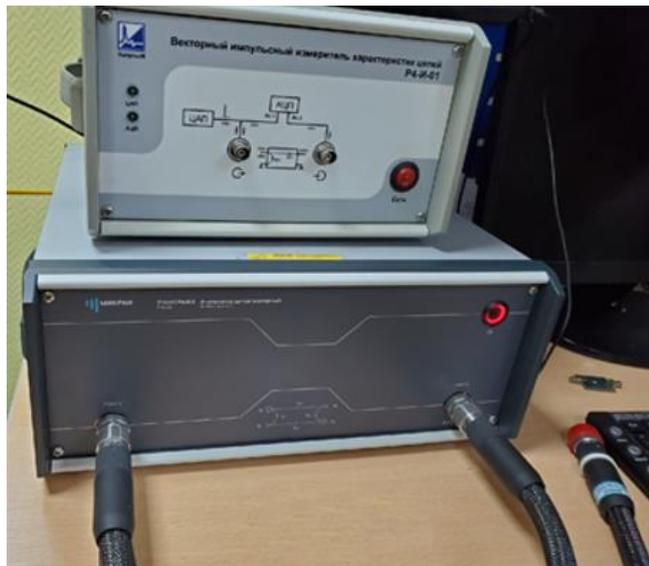
Рисунок 4.26 – Векторный анализатор электрических цепей «Панорама» P4226
