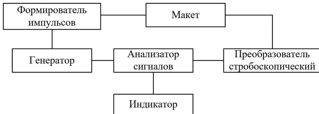
Рисунок 4.12 – Экспериментальная установка, предназначенная для регистрации сигналов во временной области
