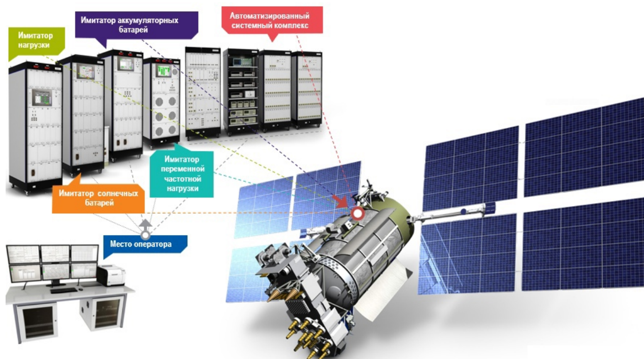
Рисунок 6.10 — Автоматизированная система контроля энергопреобразующей аппаратуры
