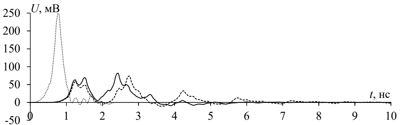
Рисунок 2.32 – Формы напряжения на входе (···) и выходе однокаскадного МФ в дифференциальном (—) и синфазном (- - -) режимах
