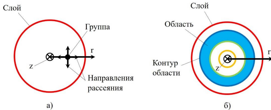
Рисунок 3.38 – Схема рассеяния электронов пучка на молекулах остаточного газа (а) и схема деления слоев на кольцевые области (б)
