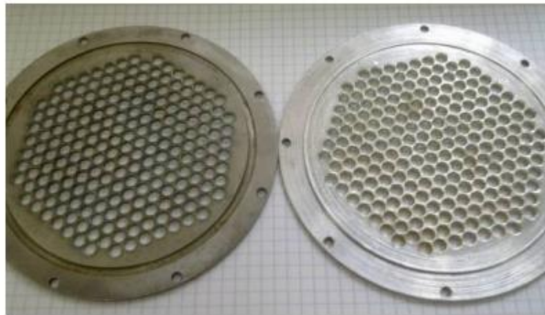
Рисунок 3.48 – Сборный анодный электрод с диаметром отверстий d_1=5 мм
