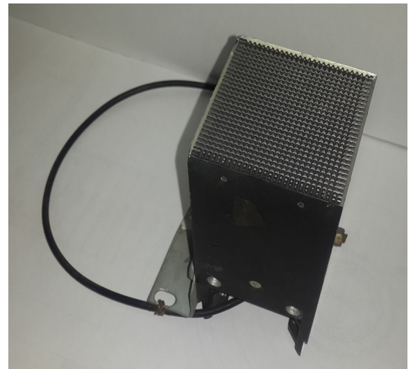
Рисунок 2.21 – Конструкция калориметрического преобразователя типа ТПИ–2М.1 (слева) и его фото (справа): 1 – приемный элемент; 2 – батарея хромель–копелевых термопар; 3 – нагреватель; 4 – дюралевый корпус
