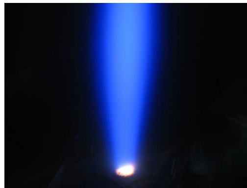
Рисунок 2.3 – Фотография свечения анодной плазмы в области дрейфа электронного пучка, а также свечения мишени за счет нагрева электронным пучком субмиллисекундной длительности
