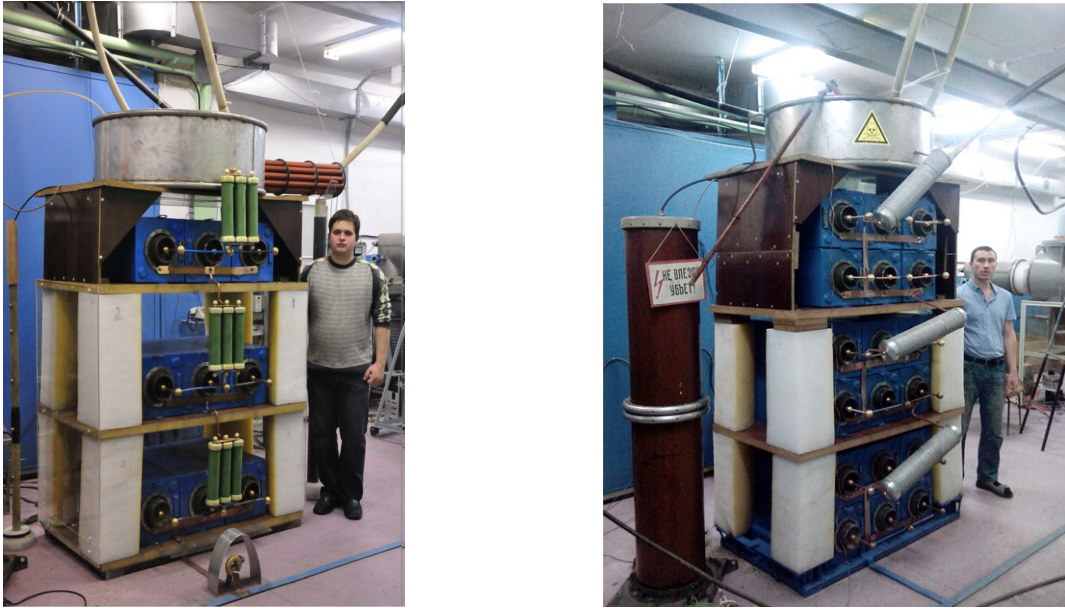
Рисунок 2.15 – Фотографии высоковольтной конденсаторной батареи источника электронов «Килоампер»: слева – общей емкостью 3 мкФ, справа – общей емкостью 6 мкФ
