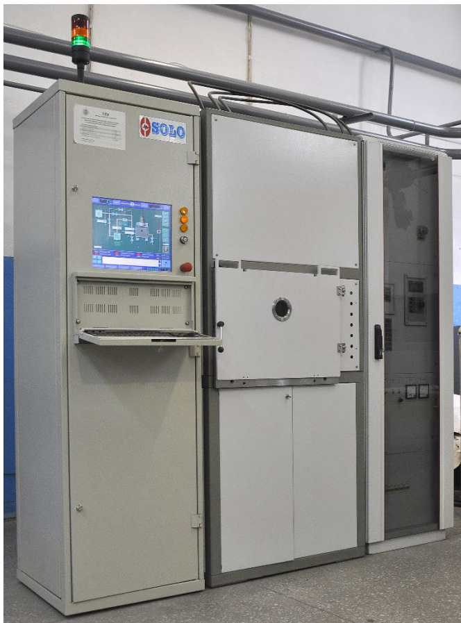
Рисунок 2.2 – Фотография источника электронов «СОЛО»
