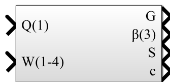
Рисунок 2.13 - Имитационная модель измельчения: Q_1 – производительность мельницы по руде, т/ч; W – расходы воды в точки 1-4 схемы измельчения, м 3 /ч; G – масса внутримельничного заполнения, т; \beta_3 – содержание расчетного класса в продукте 3, %; S – механическая вибрация мельницы, %; c – циркулирующая нагрузка, %
