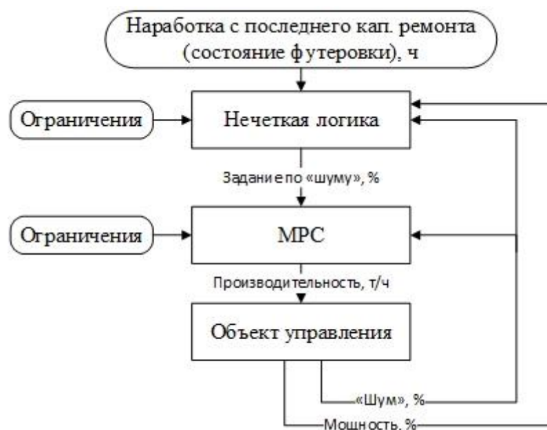
Рисунок 1.2 – Структура САУ на базе нечеткой логики и MPC регулятора
