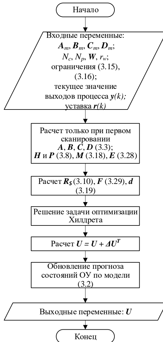
Рисунок 3.22 – Блок-схема алгоритма MPC
