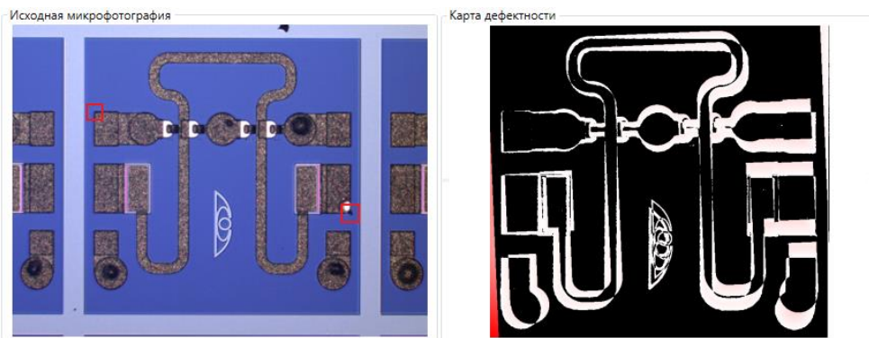
Рисунок 4.31 – Неудовлетворительное совмещение микрофотографии и фотошаблона из-за значительного загрязнения места поиска точки совмещения (места расположения точек совмещения выделены на микрофотографии красными квадратами)
