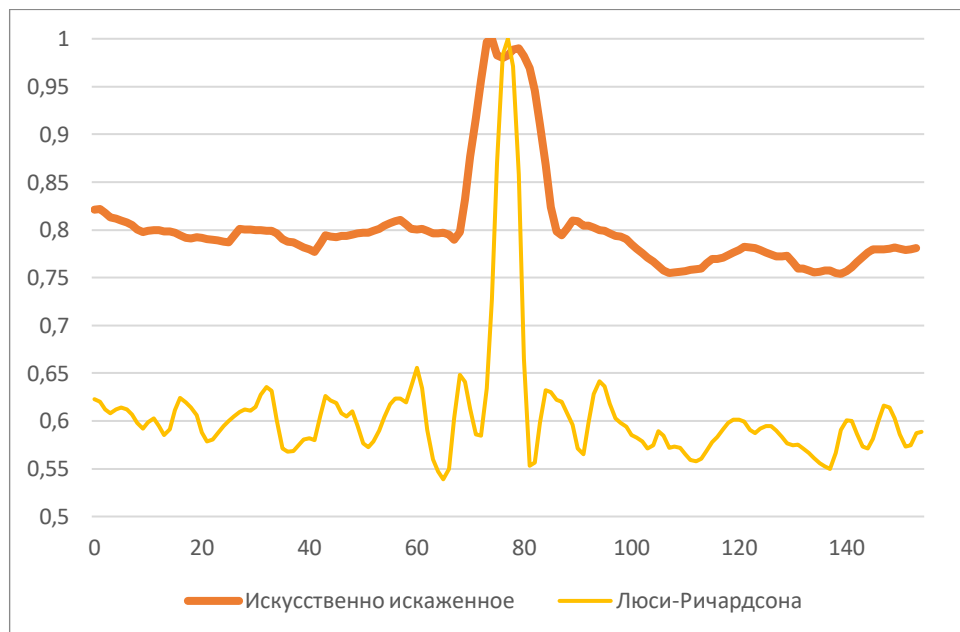
Рисунок 4.13 – Профиль яркости объекта интереса после фильтрации Люси – Ричардсона
