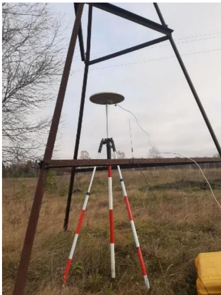
Рисунок 2.4 – Базовая станция на пункте ГГС
