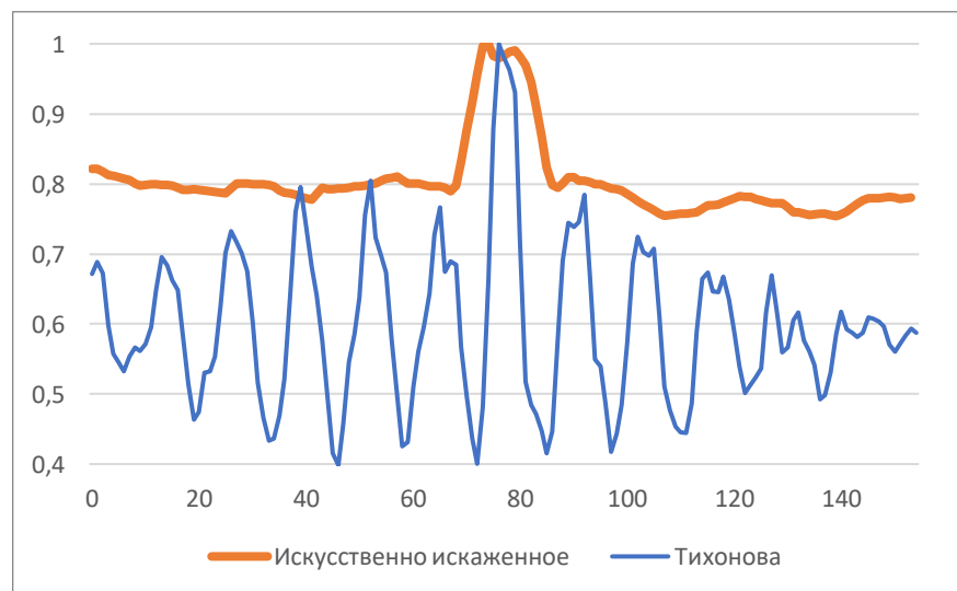
Рисунок 4.16 – Профиль яркости объекта интереса после фильтрации по методу Тихонова
