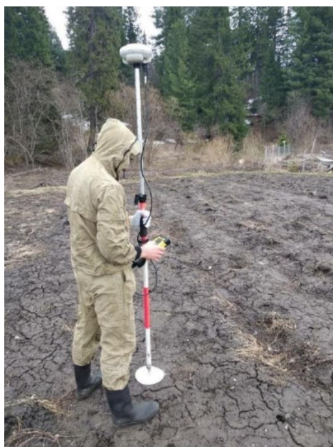
Рисунок 2.5 – Определение точных координат контрольных точек
