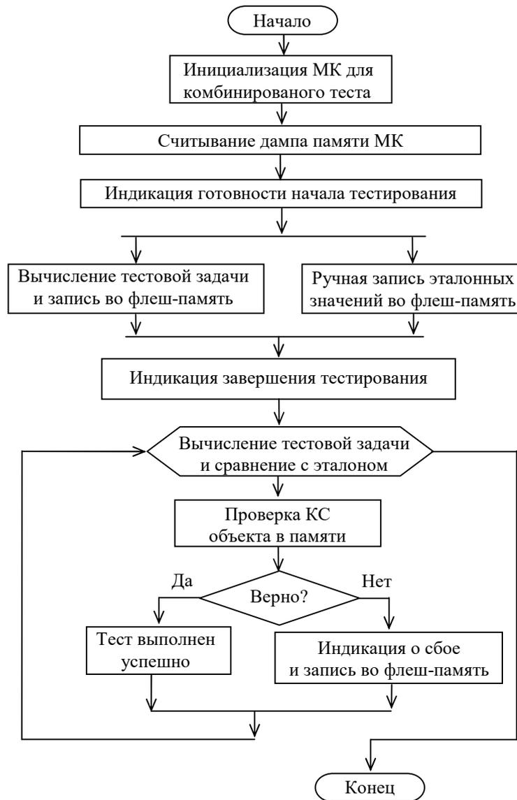
Рисунок 4.8 – Универсальный алгоритм проверки работоспособности вычислительных блоков МК
