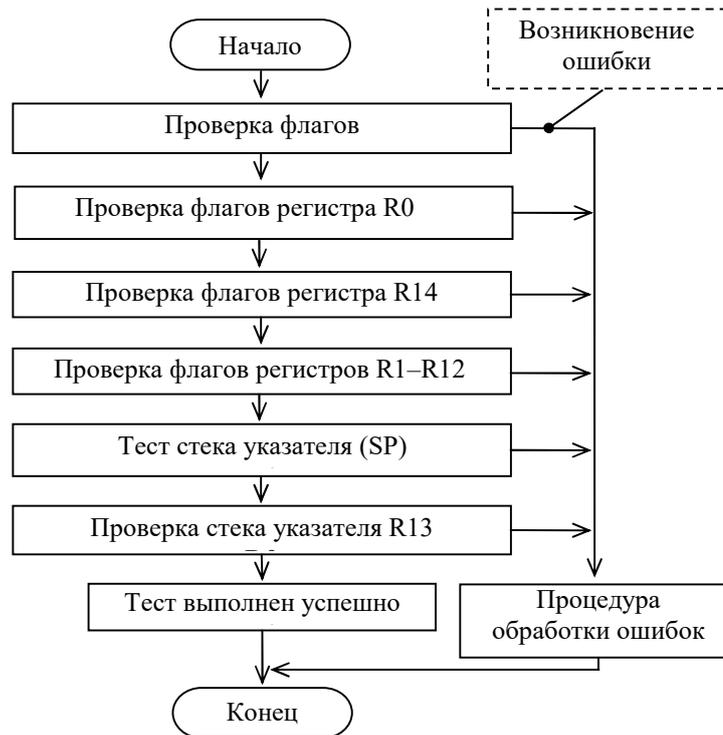
Рисунок 4.12 – Структурная схема самотестирования процессора МК
