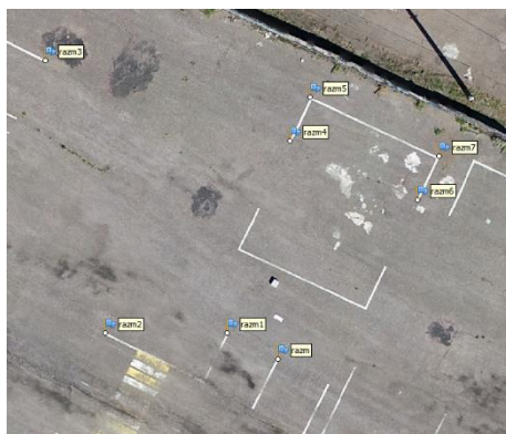
Рисунок 4.1– Расположение контрольных точек на местности
