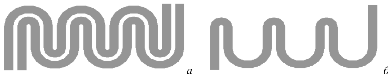
Рисунок 3.19 – Модель макета МФ с лицевой связью [159]: виды верхнего (а) и нижнего (б) слоев
