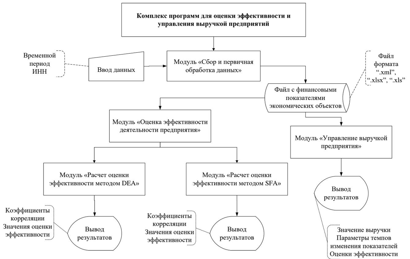
Рисунок 4.3 – Функциональная схема комплекса программ
