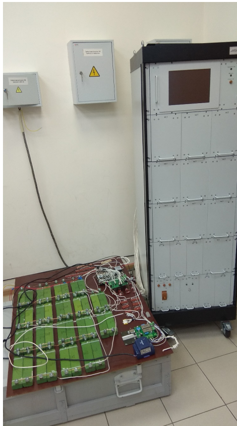
Рисунок 4.10 – Структурная схема устройства характериографа ( a ); характериограф в составе рабочего места ИБС ( б )
