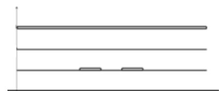
Рисунок 4.2 – Поперечное сечение стека печатной платы
