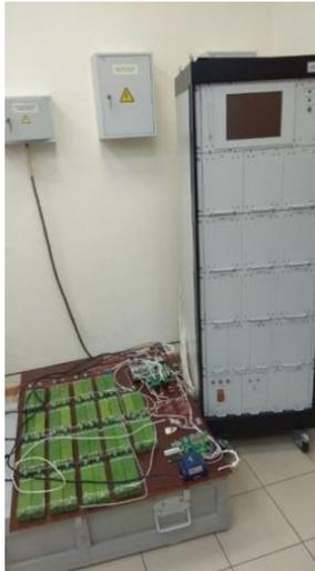
Рисунок 13 – Характериограф в составе рабочего места ИБС
