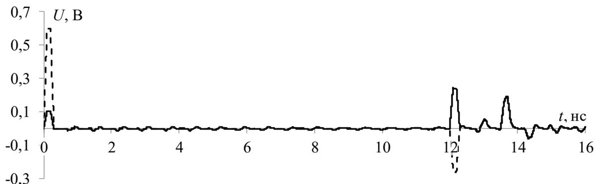
Рисунок 3.4 – Формы напряжения на входе (---) и выходе (—) витка при  $N=19$  при воздействии импульсом длительностью 300 пс
