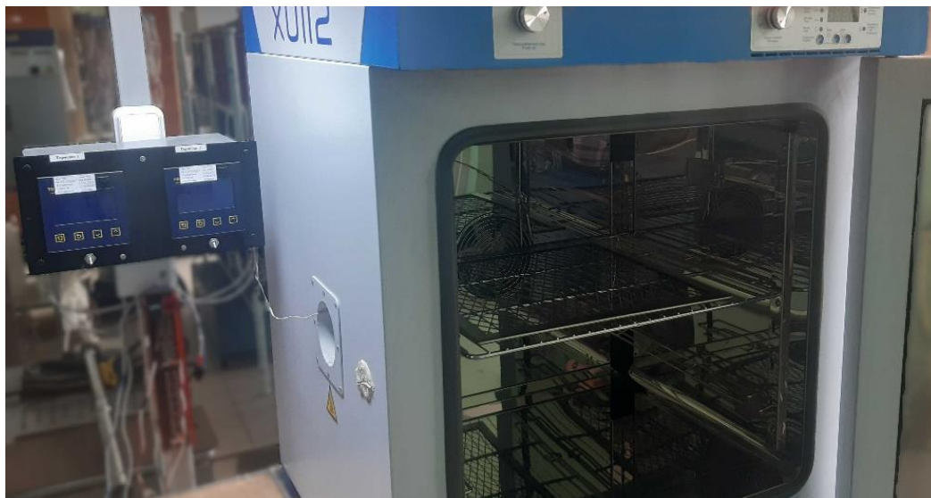
Рисунок 3.10 – Внутренний отсек испытательной камеры с окном ввода измерительной оснастки на боковой стороне и двумя дополнительными измерителями температуры
