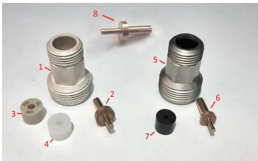
Рисунок 2.16 – Внешний вид измеряемых изоляторов и резонаторов: 1 – корпус резонатора № 1, 2 – центральный проводник с возбуждателем резонатора № 1, 3 – изолятор из ПЭЭК, 4 – изолятор из AR200, 5 – корпус резонатора № 2, 6 – центральный проводник с возбуждателем резонатора № 2, 7 – изолятор из ПИ, 8 – удлиненный полностью позолоченный центральный проводник резонатора №2
