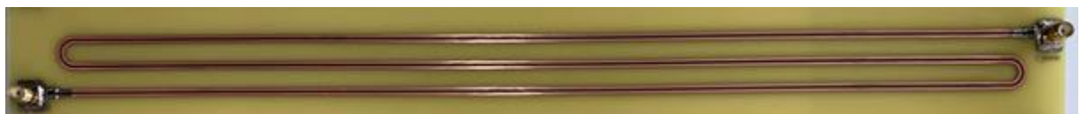
Рисунок 4.58 – Фотография прототипа с исполнением опорного проводника в центре
