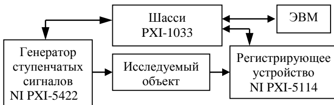
Рисунок 1 – Структурная схема установки для автоматизированного измерения переходных характеристик объекта
