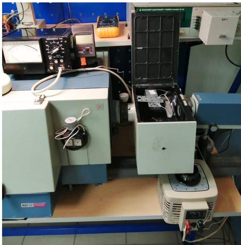
Рисунок 4.2 – Внешний вид макета установки для исследования термолюминесценции
