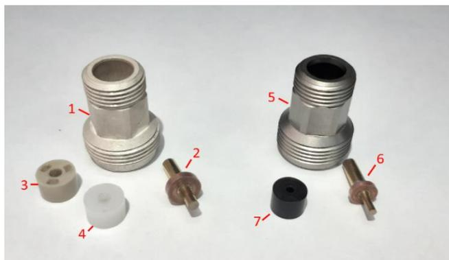
Рисунок 7 – Внешний вид измеряемых изоляторов и резонаторов: 1 – корпус резонатора № 1, 2 – центральный проводник с возбудителем резонатора № 1, 3 – изолятор из ПЭЭК с внутренними полостями, 4 – изолятор из AR200, 5 – корпус резонатора № 2, 6 – центральный проводник с возбудителем резонатора № 2, 7 – изолятор из ПИ
