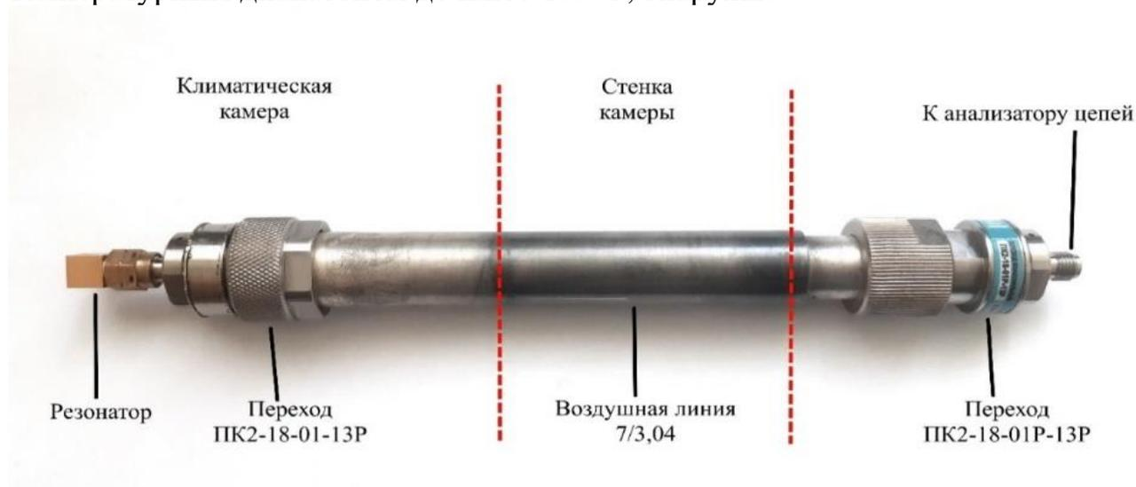
Рисунок 13 – Внешний вид измерительной оснастки
