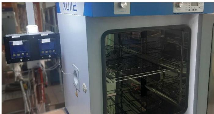
Рисунок 12 – Испытательная камера с окном ввода измерительной оснастки на боковой стороне и двумя дополнительными измерителями температуры
