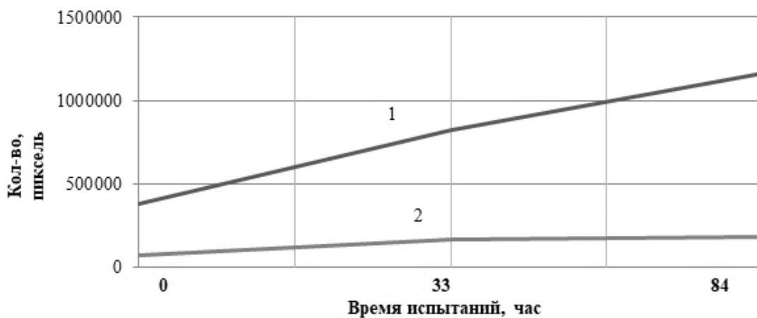
Рисунок 2.10– Зависимость количества пикселей от времени испытаний (1 – зеленый цвет; 2 – желтый цвет)
