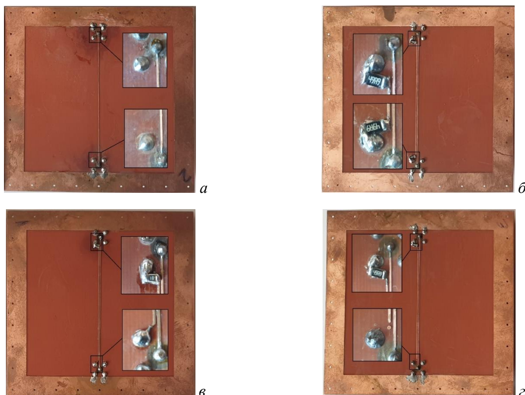
Рисунок 3.1 – Макеты измерительных ПП: одиночная МПЛ ( а ) и связанная МПЛ, имеющая различные граничные условия (согласованная на 50 Ом ( б ), с одной из сторон КЗ ( в ) и ХХ ( г )) на концах пассивного проводника
