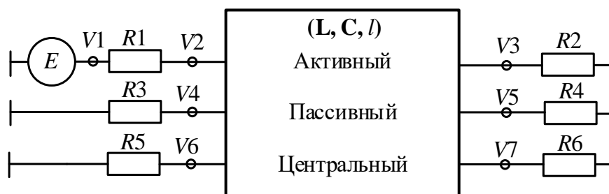
Рисунок 4.10 – Эквивалентная схема структуры с МР в ТЕМ-камере
