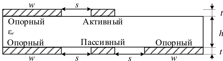
Рисунок 1.4 – Поперечное сечение структуры для способа трассировки двухсторонней ПП с МР без одного опорного проводника [85]
