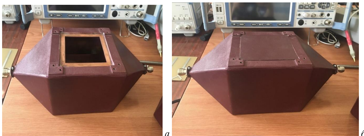
Рисунок 1.21 – Лабораторный макет классической ТЕМ-камеры с открытой (а) и закрытой (б) апертурой
