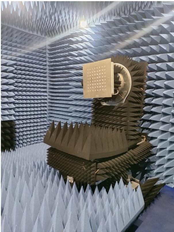
Рисунок 5.7 – Размещение микрополосковой антенной решетки на расстоянии 3.2 м от зонда
