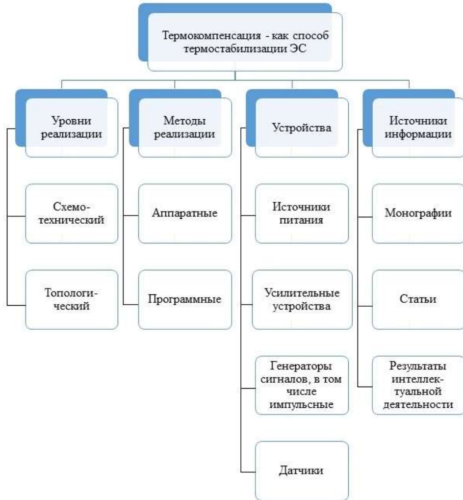
Рисунок 1.11 – Классификационные признаки термокомпенсации, как способа термостабилизации
