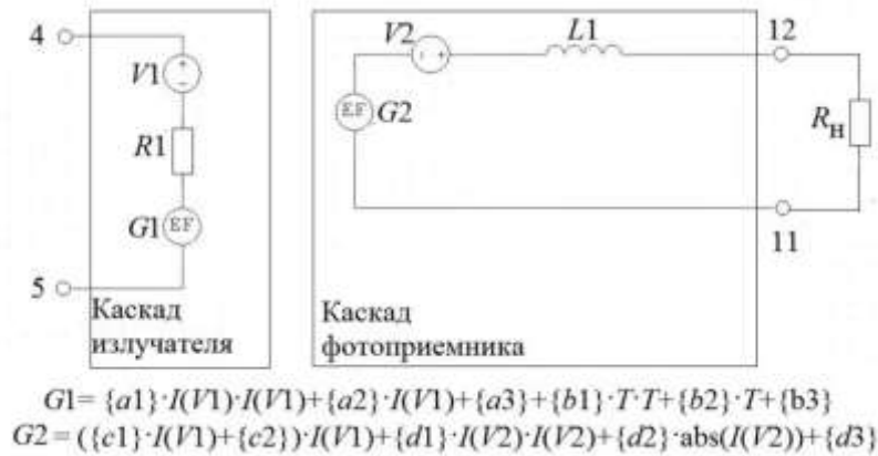
Рисунок 3.20 – Макромодель транзисторной оптопары 3ОТ122А
