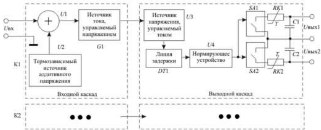
Рисунок 3.32 – Структуризация модели МОП-реле 249КП4АТ
