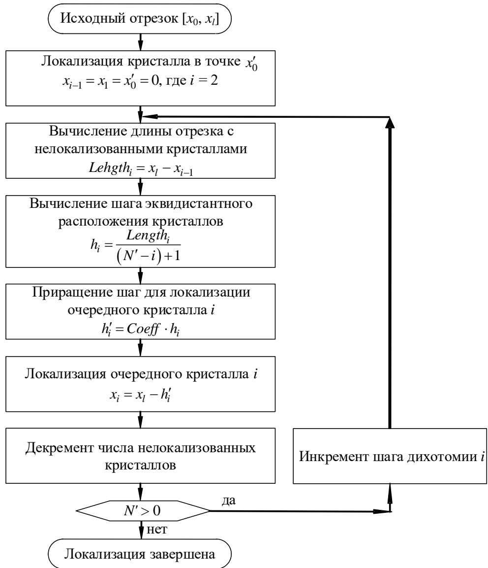
Рисунок 5.5 – Алгоритм процесса дихотомии для случая с четным числом кристаллов
