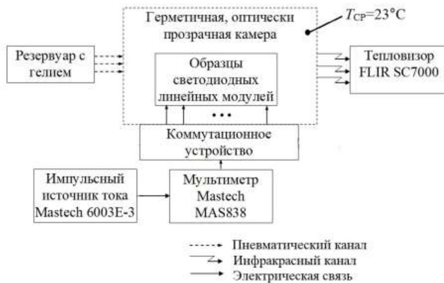
Рисунок 5.17 – Структурная схема измерительной установки
