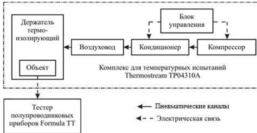
Рисунок 3.27 – Структурная схема измерительной установки
