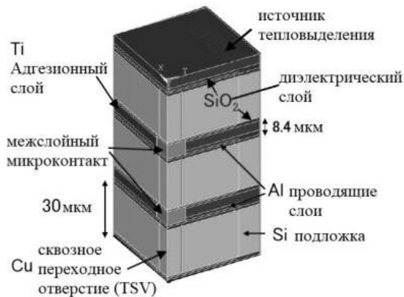
Рисунок 5.12 – Структура тестовой ОИС
