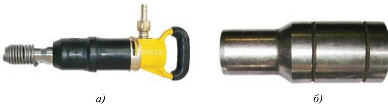
Рис. 3.3.2.1.1 а) Внешний вид отбойного молотка МО-1Б; б) Ударник отбойного молотка МО-1Б
