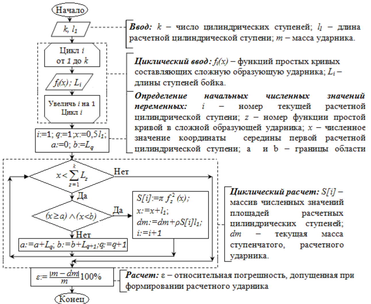
Рис. 2.1.3 Блок-схема алгоритма численного моделирования многоступенчатого бойка
