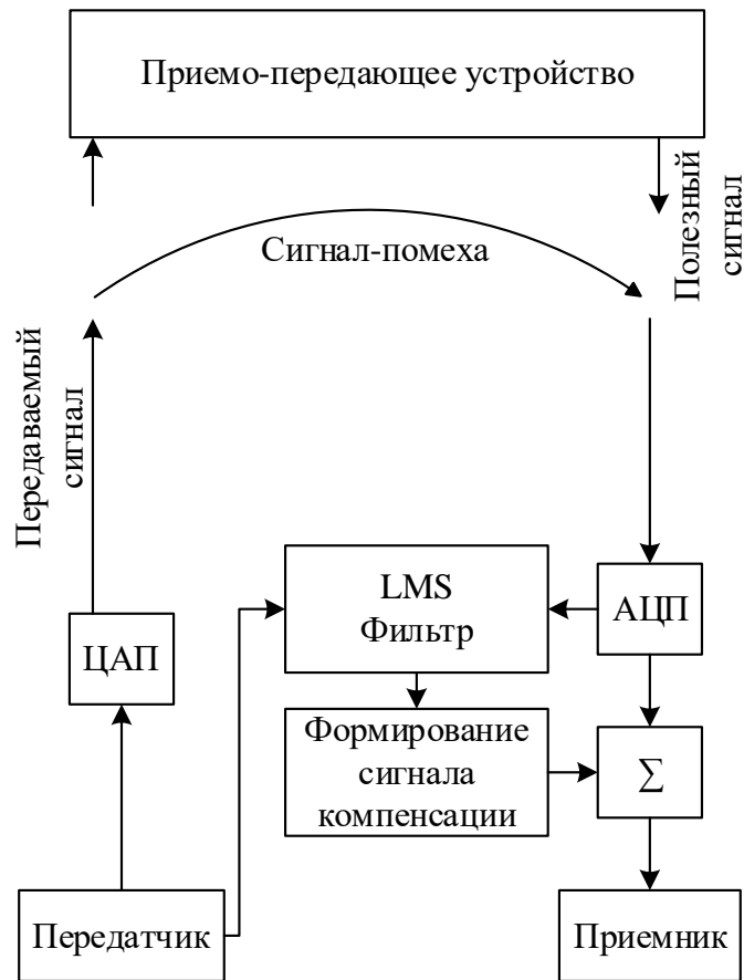
Рисунок 4.6 – Функциональная схема цифровой компенсации
