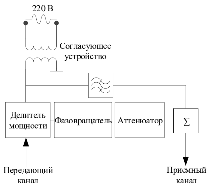
Рисунок 4.3 – Схема аналоговой компенсации с использованием перестраиваемого аттенюатора и фазовращателя
