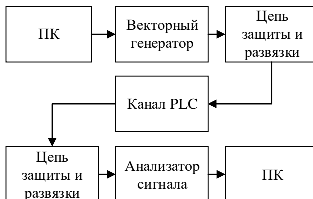
Рисунок 3.20 – Структурная схема макета передачи информации по сетям электропитания
