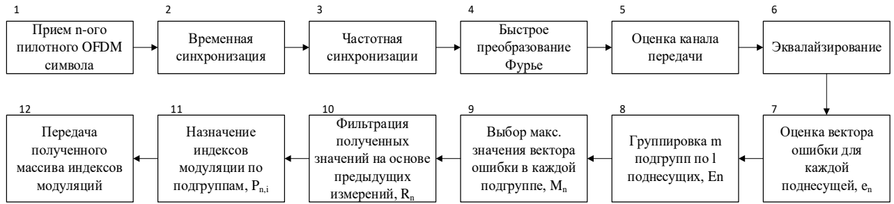
Рисунок 3 – Функциональная схема предлагаемого метода адаптивной модуляции
