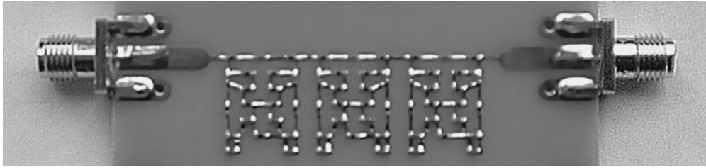
Рисунок 1.11 – Неотражающий полосно-пропускающего фильтр, схема фильтра (а) и изготовленный макет (б) [51]
