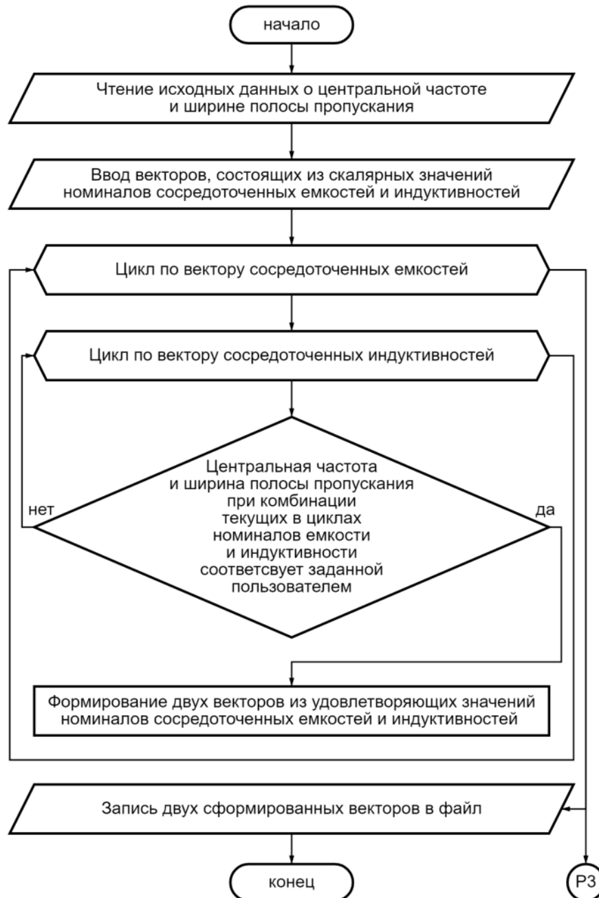
Рисунок 4.7 – Схема-алгоритм выборки удовлетворяющих номиналов сосредоточенных элементов RLC цепи
