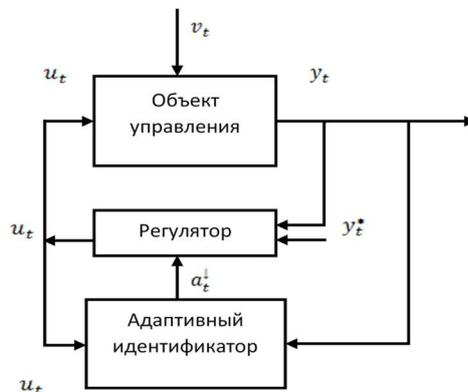
Рисунок 11. – Общая укрупненная структурная схема адаптивной системы управления с подстраиваемой моделью объекта управления
