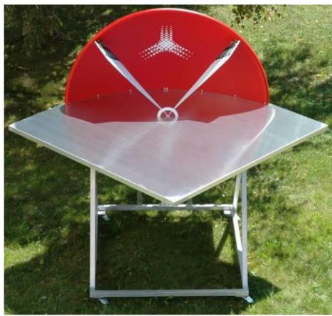
Рисунок 1.3 – Изображение антенны HIRA180 ( a ) и пример генерируемой ей напряженности электрического поля на расстоянии 25 и 50 м ( б )
