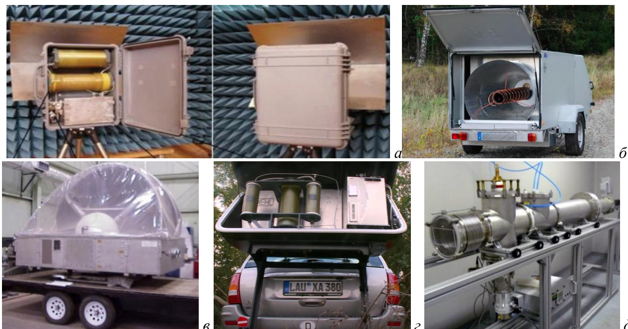
Рисунок 1.2 – Пример реализации высококомбинированного (а), мобильного (б, в, г) и стационарного (д) источников мощных ЭМП из [48, 49]
