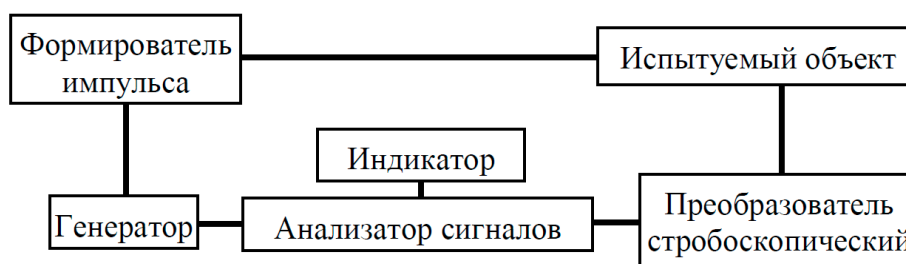
Рисунок 4.2 – Схема экспериментальной установки для анализа временных характеристик
