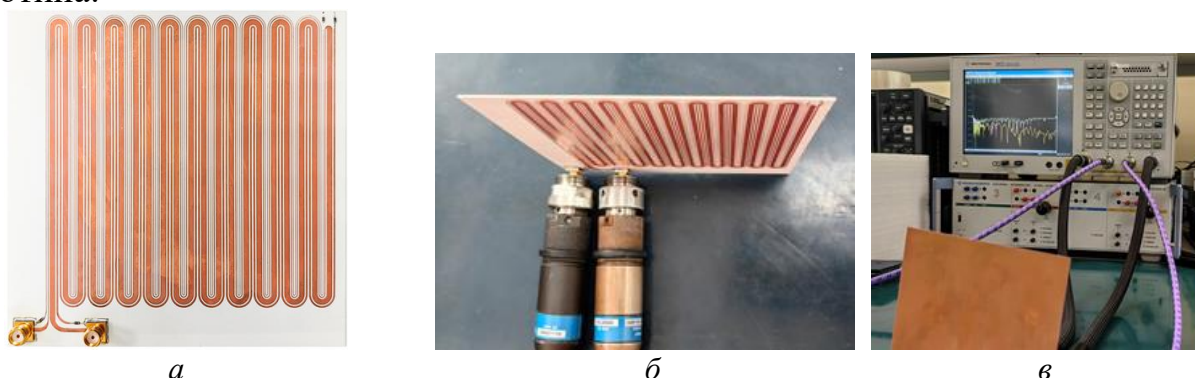
Рисунок 4.5 – Изготовленный прототип (а), подсоединённый прототип (б) и установка для измерения его частотных характеристик (в)
