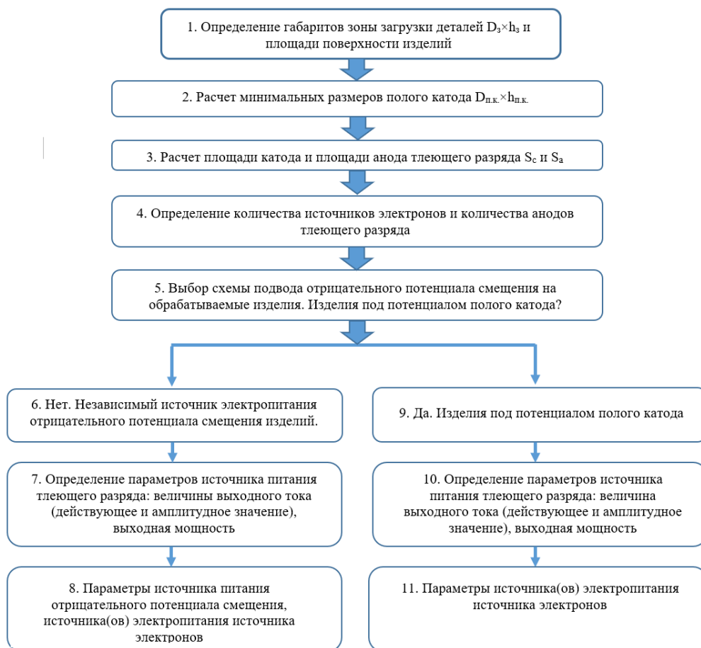
Рисунок 2 – Обобщенный алгоритм оценки и расчета конфигурации системы генерации ППО в полом катоде несамостоятельного тлеющего разряда и параметров систем электропитания
