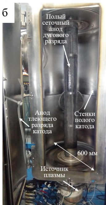
Рисунок 5 – Схема генератора газовых ППО с протяженным, длиной 1 м, цилиндрическим эмиттером электронов, генерирующим радиально-расходящийся пучок электронов (а); фотография внутреннего пространства полого катода с протяженным цилиндрическим эмиттером электронов (б)
